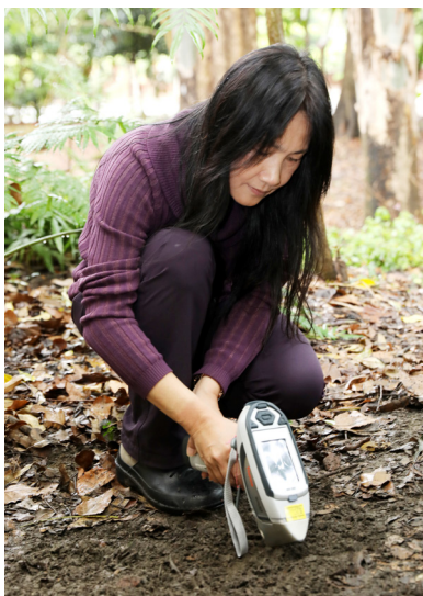
劉博士示範XRF分析儀在土壤上的採樣方法
