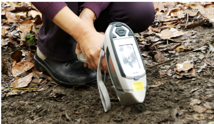
Thermo Scientific 便攜式XRF分析儀協助研究員進行現場立即重金屬分析
