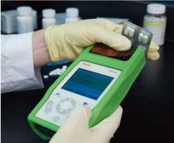
TruScan GP 分析仪可透过密封的包装进行材料鉴定，从而将污染和暴露风险降到合理范围。
