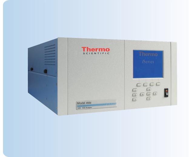
Thermo Scientific™的硫化氢与二氧化硫分析仪采用了脉冲紫外荧光技术。450i型H<sub>2</sub>S和SO<sub>2</sub>分析仪的操作原理是把H<sub>2</sub>S转化为SO<sub>2</sub>测量。由于SO<sub>2</sub>分子吸收紫外（UV）光并在某一特定波长上被激发，当SO<sub>2</sub>分子衰减到低能级时会发射出另一个波长的紫外光。即：
