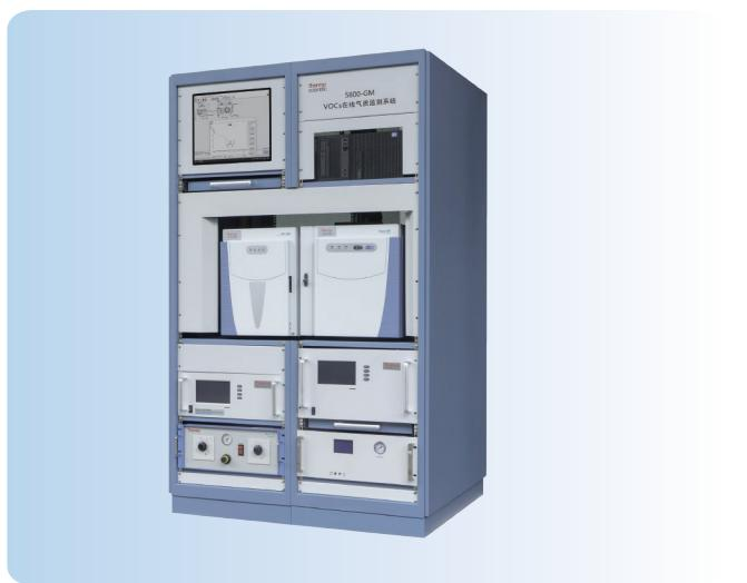
Thermo Scientific™ 5800-GM型挥发性有机物（VOCs）气质联用在线监测系统包括在线VOCs富集系统、ISQ气质联用仪和气体发生系统，通过创新系统设计、灵活软硬件配置、优化分析方法可实现对空气中VOCs组分的24小时/7天连续定性定量分析。在线VOCs富集系统为双/单富集冷聚焦设计，无需制冷剂，操作简单，能够实现对包括C2等轻组分的VOCs有效富集；气相色谱与四极杆质谱联用仪结合NIST谱库可以实现对空气中的VOCs组分进行分离并解析；可对PAMS、TO-15以及醛、酮类含氧挥发性有机物组分进行有效的富集和准确的定性定量分析，检测限低至ppt级，分析方法满足国家相关要求。该方案可以用于在线环境监测以及离线环境检测等多种场合，也可以用于车载，实现环境应急监测。
