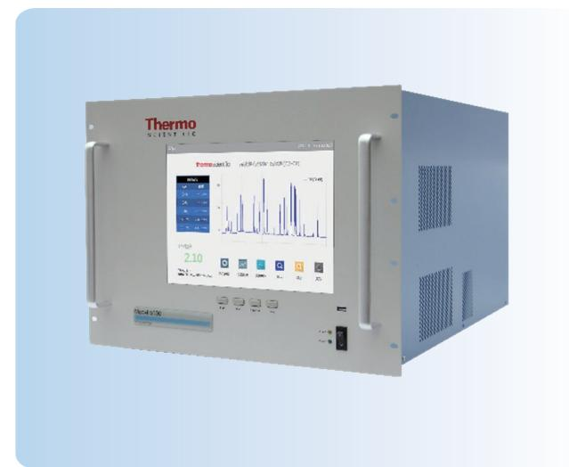
Thermo Scientific™ 5900-C臭氧前驱体在线分析仪采用技术成熟、性能稳定的样品预浓缩以及GC-FID技术，对环境空气中的VOCs组分进行24小时/7天连续定性和定量分析，也可用于苏码罐与气袋采样的分析，检测限可达ppt 级。
