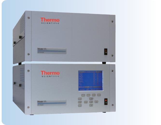
17i型氨分析仪利用了一氧化氮（NO）与臭氧（O<sub>3</sub>）反应产生荧光的基本原理。仪器有三种操作模式，NO、NOx和Nt。
