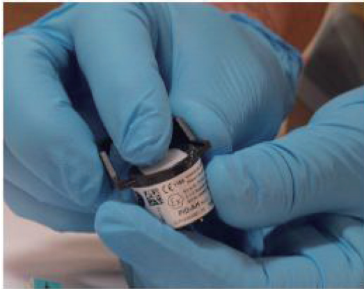
图 7-21 拆卸电极堆和灯泡
