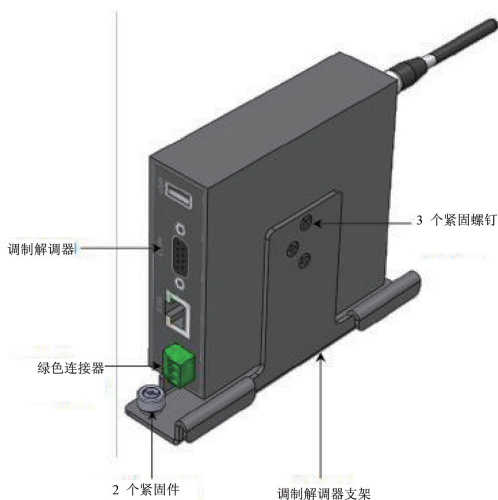
图 7-9 更换路由器 / 调制解调器
