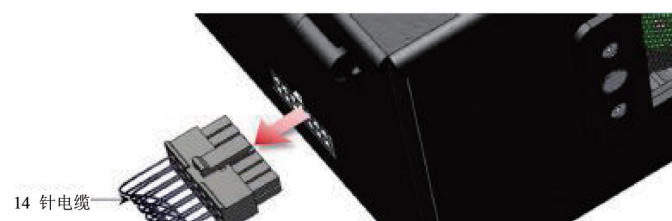
图 7-12 断开传感器接口电缆
