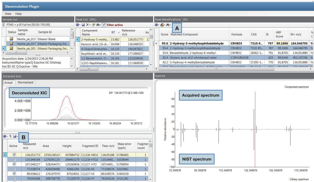
图 3. 15.98 分钟处的谱峰被鉴定为 2-羟基-5-甲基-1,3-苯二甲醛。已解析数据和谱库匹配结果在 TraceFinder 中的视图截屏。(A) 按得分排序的检索结果列表 (SI 和 HRF 组合)。(B) EI 谱图中的碎片离子列表和根据最佳结果中的元素预测的元素组成结果。
