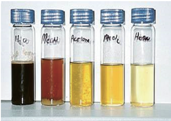
图 3-2 不同极性溶剂对同一种烟草样品进行选择性萃取的结果
