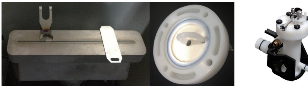
图 3-48 纯钛燃烧头、聚四氟乙烯的撞击球、雾化室
