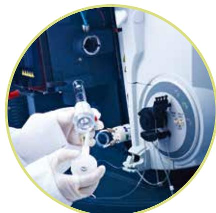
进样系统配有快速接头，操作方便，拆装快速，便于清洁和维护。结合使用其它进样组件，可以加快分析速度或分析特殊样品。
