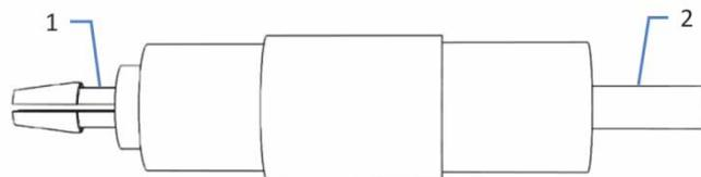
Abbildung 44: Dichtringwerkzeug
