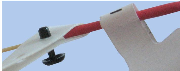
*Abb. 40: Befestigen der Säulen-ID-Chipkarte an einer Säule*
