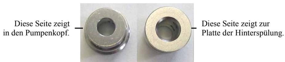
Abb. 74: Ausrichtung Hinterspülung
