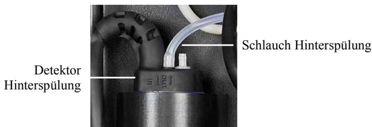
Abb. 66: Schlauchverbindung am Detektor der Hinterspülung
