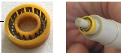
Abb. 72: Ausrichtung des Kolbendichtrings
