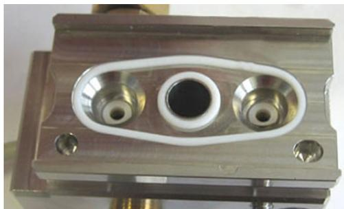
Abb. 73: Dichtring im Pumpenkopf eingesetzt
