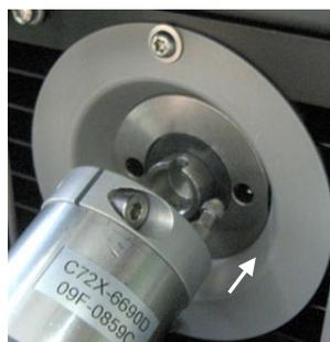
Abb. 36: Ausrichten des Ventils
