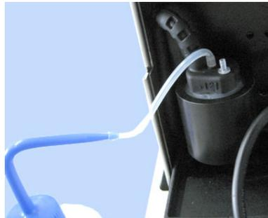
*Abb. 28: Füllen des Anschlussports mit Wasser*
