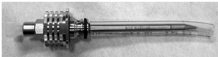
Abbildung 34: Zerstäuber mit Schutzschlauchstück und Verschlussstopfen am Flusseinlass
