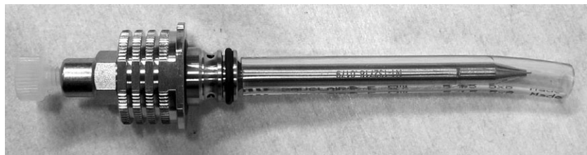
Illustration 28: Nébuliseur avec tube de protection et bouchon sur l'entrée d'écoulement
