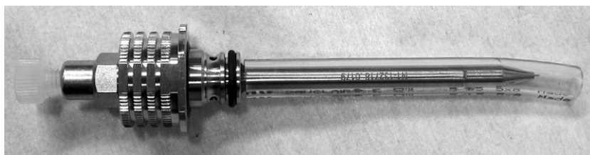
Illustration 11: Nébuliseur avec tube de protection et bouchon sur l'entrée d'écoulement
