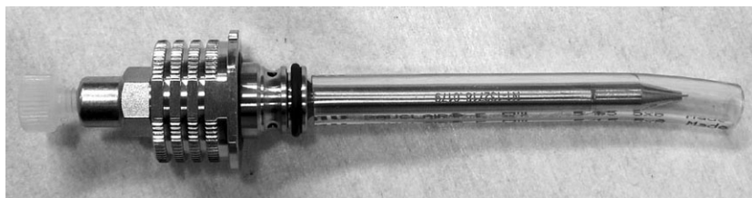
图 28: 带保护管和流入口插塞的喷雾器
