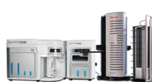
自动化机械臂 + 高通量流式 细胞仪 Attune NxT
