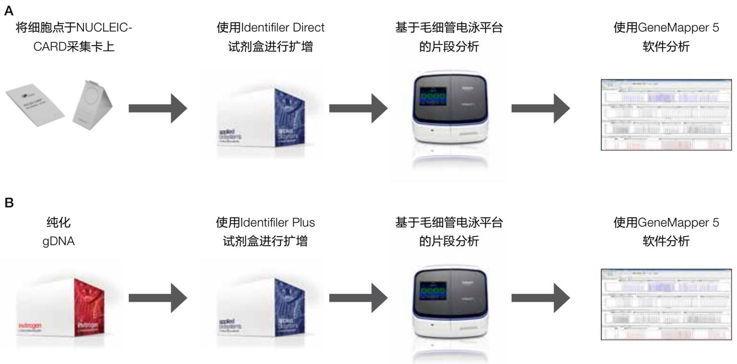
**图1. 细胞系鉴定流程。两种方法可鉴定细胞系。(A)** 将细胞点在NUCLEIC-CARD采样卡上，用Identifiler Direct试剂盒直接扩增卡片，并使用GeneMapper 5软件在Applied Biosystems™ CE仪器上进行片段分析。**(B)** 也可用Identifiler Plus试剂盒扩增从细胞系中纯化的gDNA，并使用毛细管电泳和GeneMapper 5软件分析片段。
