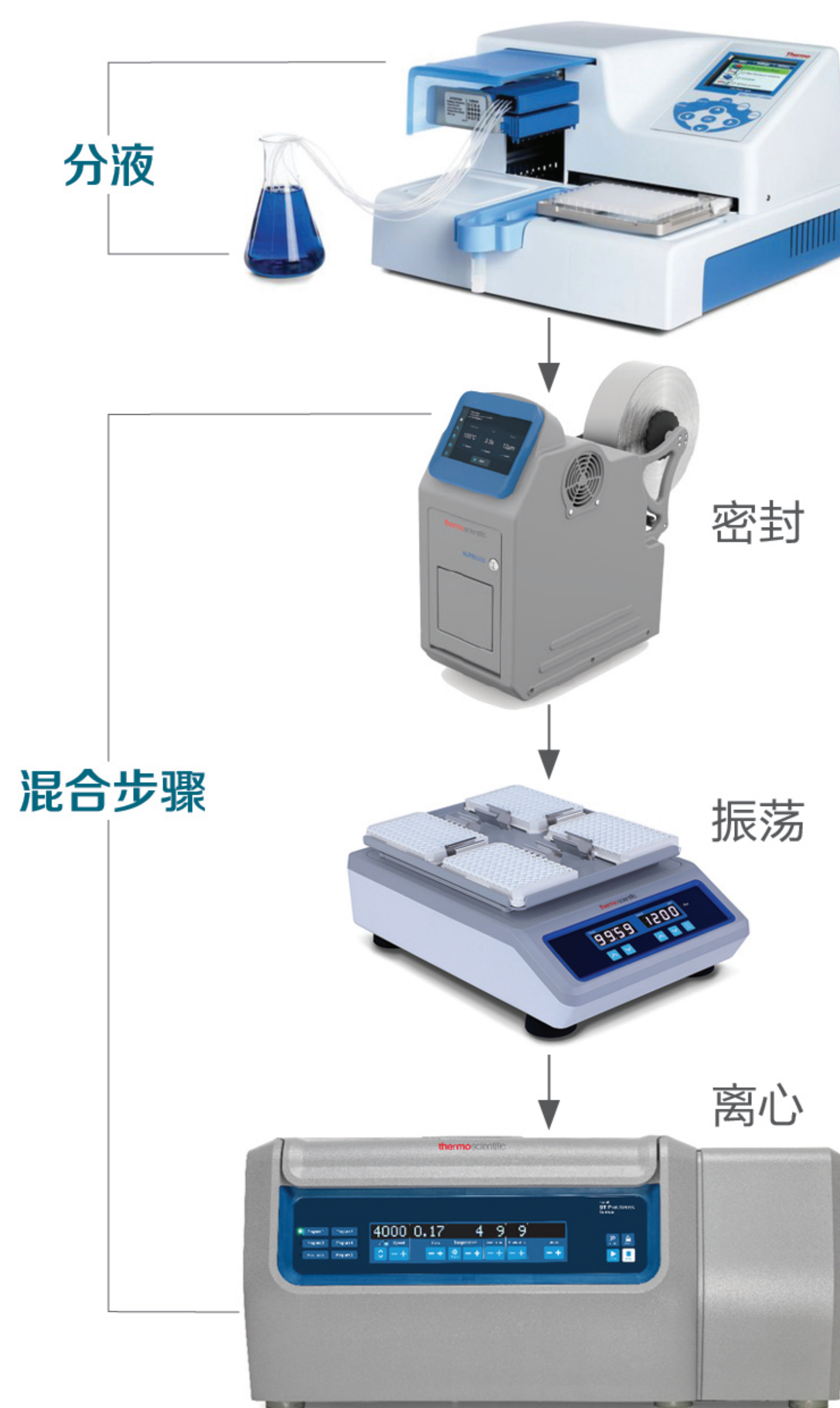
图1. 高通量Multidrop Combi自动分液器工作流程
