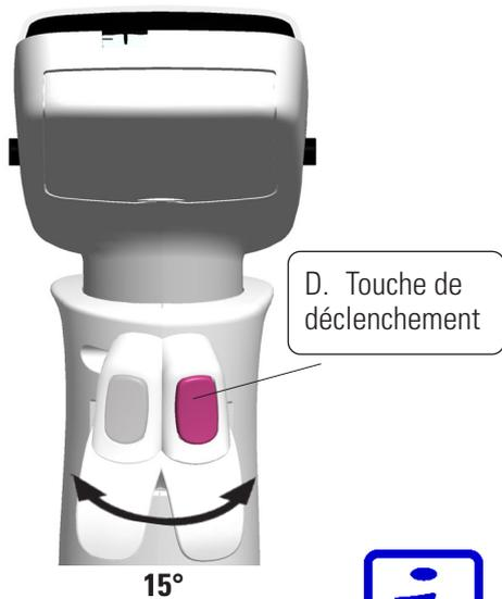
**D. Touche de déclenchement :** actionnée par l'index elle sert à aspirer et distribuer le liquide. Elle est aussi utilisée pour lancer le mélange. La touche de déclenchement et le repose-doigt peuvent être pivotés de 15 degrés dans les deux directions pour assurer une position de pipetage optimale.
