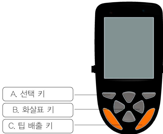
그림 B1. E1-ClipTip 키패드
