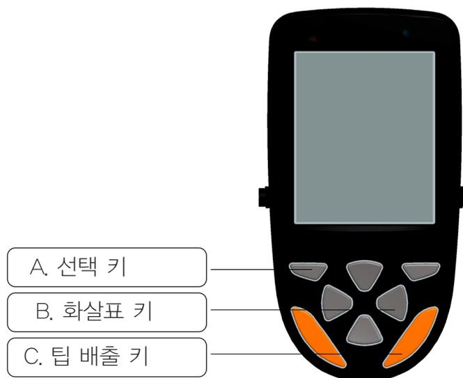
그림 B1. E1-ClipTip 키패드
