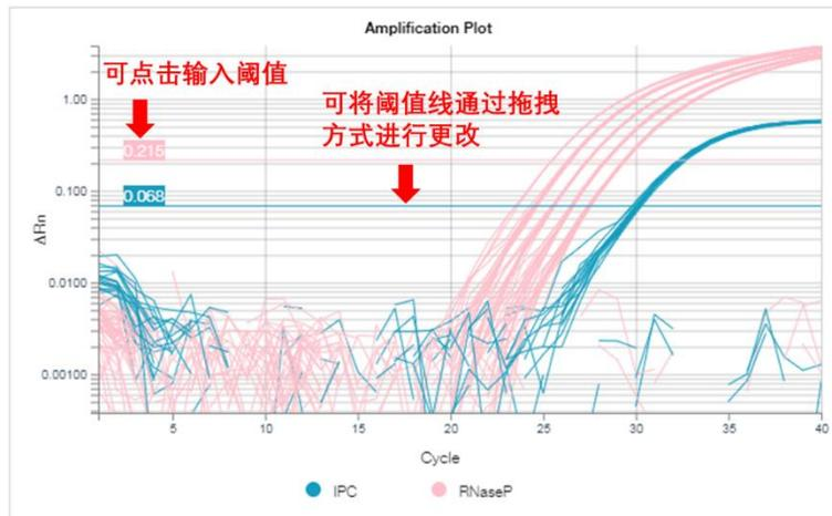
或通过右上角 Actions→Analysis Setting 进行阈值线的更改。建议对不同的基因进行分别设置。此外，可在 Well Cq 中对每条扩增曲线的基线起始和结束循环数进行单独设定。
