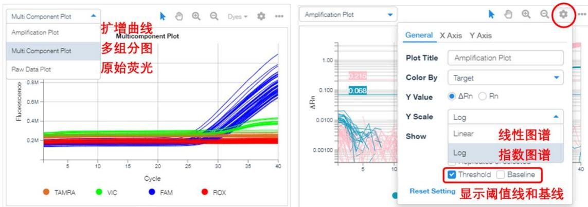
更改阈值：自动分析得到的阈值和阈值线展示在扩增曲线上，可通过输入数值或者拖拽阈值线的方式更改阈值，确保阈值线通过扩增曲线的指数增长期。
