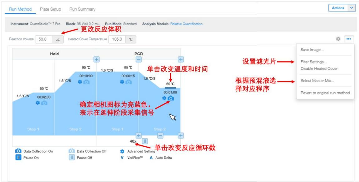
如需添加或删除反应阶段 (Stage) 和反应步骤 (Step)，可将鼠标放在对应位置，点击加减号进行更改。
