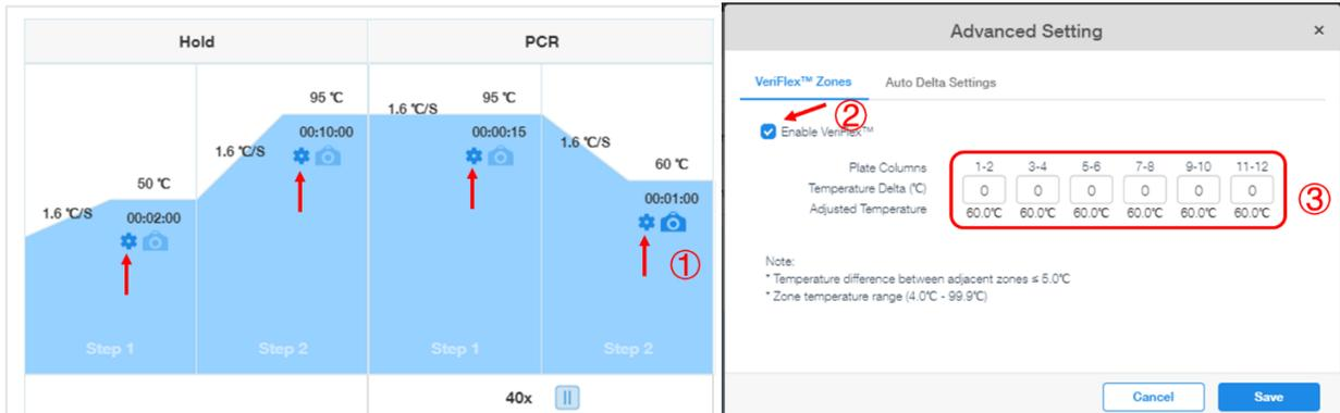
注：梯度反应温度设置仅限于96孔加热模块。QuantStudio 6 Pro 可设置3个反应温度梯度；上图为QuantStudio 7 Pro示意图，可设置6个梯度反应温度。
