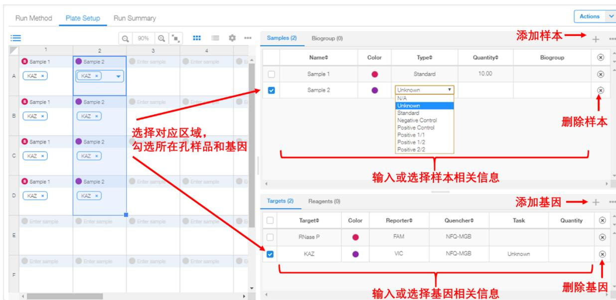
在右侧基因信息栏 (Targets) 内点击 **+** 添加新的基因：输入基因名称 (Target)、该基因扩增曲线的颜色 (Color)、该基因探针的报告荧光基团 (Reporter) 和淬灭基团 (Quencher)，如果使用的是 SYBR Green 染料，或者淬灭基团是其他形式的非荧光淬灭基团 (如 BHQ) 在 Quencher 处选择 None。
