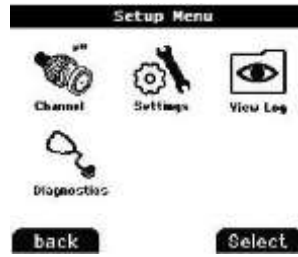
Einstellungsmenü des Star A211 pH-Messgeräts
