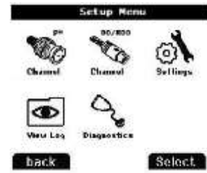
Einstellungsmenü des Star A214 pH/ISE-Messgeräts
