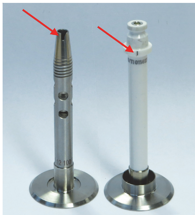
Fig. 1: géométrie de mesure classique avec un sommet équipé d'une encoche (à gauche) et une géométrie de mesure Connect Assist avec une marque sur son arbre en céramique pour un montage défini (à droite).
