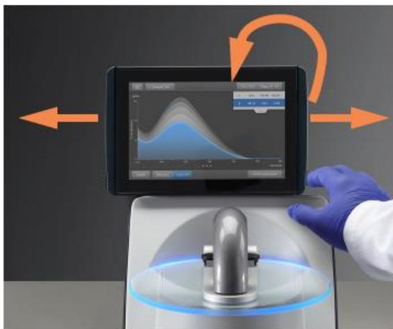
NanoDrop One<sup>C</sup> 配备内置的 7 英寸高清触摸屏，其中预装了简便易用的仪器控制软件。可根据个人喜好将触摸屏滑向左侧或右侧，也可前后倾斜以获得最佳视觉效果。
