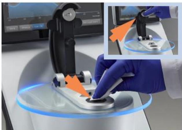
2. 抬起仪器检测臂，用新的实验室无尘纸擦拭上下基座。
