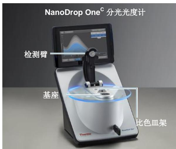
**注** 将该仪器置于远离通风口和排气风扇的位置以最小化蒸发。
